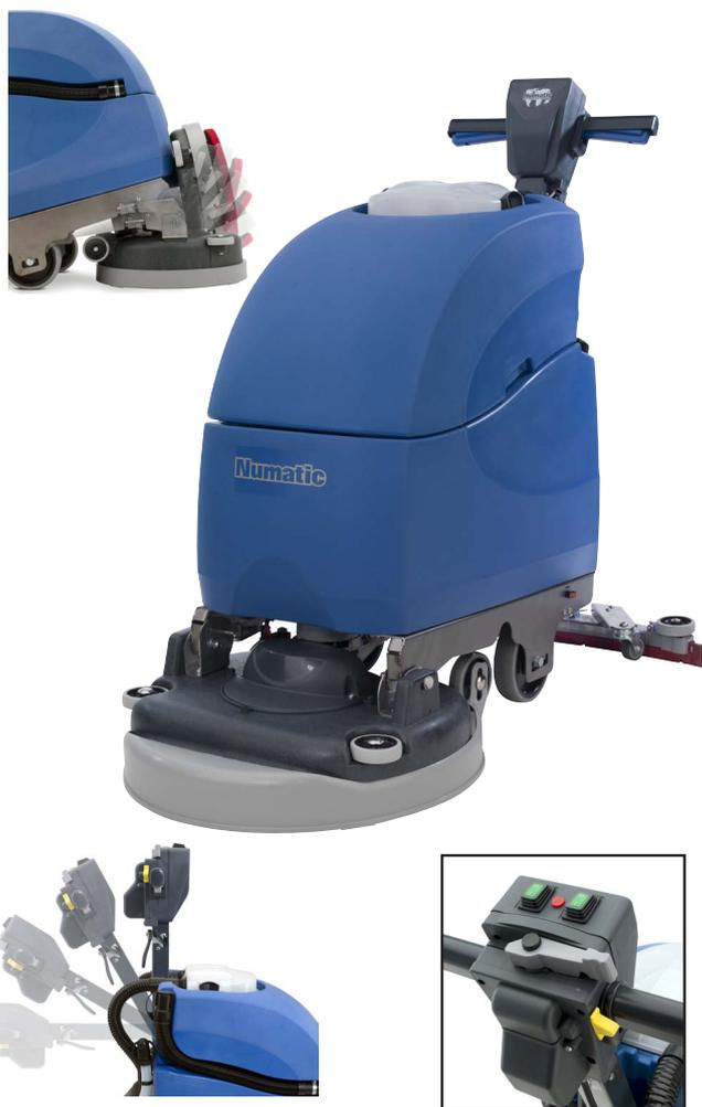
Autolaveuse équipée de batteries 100Ahr (gel 24V sans entretien et sans cycle de charge) avec chargeur intégré pour une grande autonomie. Système de réglage de pression de brosse pour adapter la machine au type de sol. Dotée d'un châssis inox, d'un timon de commandes ergonomique, pliant et ajustable, Fonction HI/LO.
