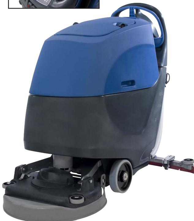
Autolaveuse équipée de batteries 100Ahr (gel 24V sans entretien et sans cycle de charge) grande capacité 60L avec chargeur intégré pour une grande autonomie. Système de réglage de pression de brosse pour adapter la machine au type de sol. Dotée d'un châssis inox, d'un panneau de contrôle de type VARIO d'utilisation intuitive, de la Fonction HI/LO...
