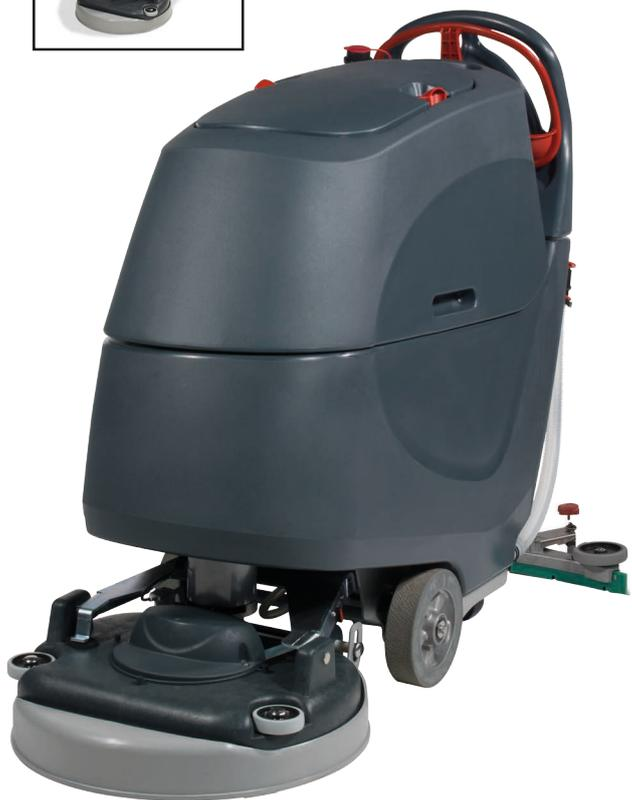
Autolaveuse à traction semi-automatique, équipée de batteries 100Ahr, gel 24V sans entretien et sans cycle de charge, grande capacité avec chargeur intégré (grande autonomie). Système de réglage de pression de brosse pour s'adapter au type de sol. Châssis inox, panneau de contrôle ultra-simplifié. Tête de brosse Structofoam. Flexible de vidange eaux usées, extensible et intégré au réservoir. Remplissage du réservoir eau propre avec bouchon et flexible extensible Flexi-fill.
